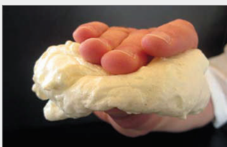
la schiuma PU resta elastica anche dopo l'essiccazione
